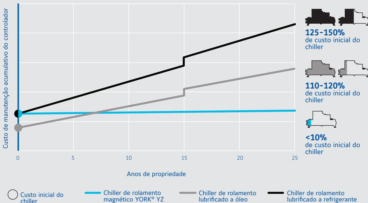
Todos os chillers centrífugos precisam de manutenção programada, limpeza dos tubos e verificação dos níveis de refrigerante. A distinção nas diferenças de manutenção está dentro do sistema de acionamento. Sem as desmontagens programadas do compressor, trocas de filtro ou qualquer manutenção em um sistema de lubrificação de rolamento complexo, o YORK® YZ é incomparável em termos de economia com manutenção, durante toda a vida útil do chiller.
